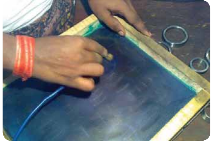
Yanlış markalar bu şekilde görüldüğü gibi rulmana serigrafisi ile markalanır.
